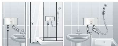
Рисунок 1. Можливі варіанти встановлення ПЕВН
